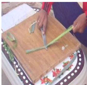
Figure (III.10) : Extraction manuelle des fibres d'Agave.
