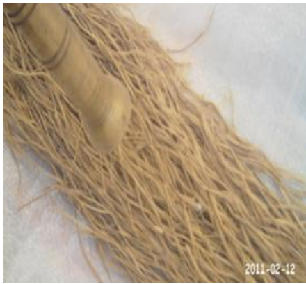
Figure (III.8) : Écrasement fibre d' HALFA Figure (III.9) séparation des fibres tamisée.
