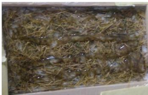
Figure (III.43) : Comment ajouter de la résine à la fibre Diss.
