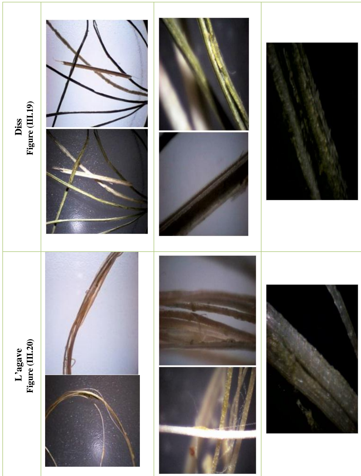
Fig. (III.21) Traitement des fibres par une solution de soude
