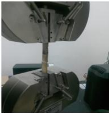
Figure IIV.5: procédé du test de traction
