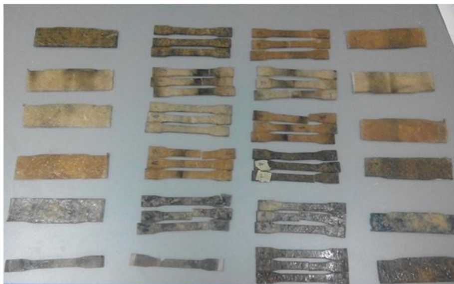
Figure (IV.6): échantillons obtenus après le procédé de traction
