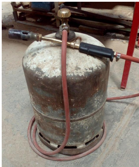
Fig III. 14 : Chalumeau pour galvanisation à chaud
