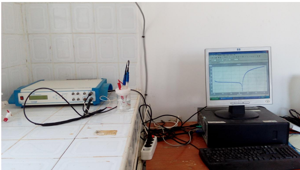
Fig III. 23 : Le dispositif de mesure électrochimique (potentiostat)
