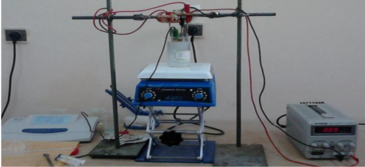
Fig III. 8 : Schéma de montage d'électrodeposition.
