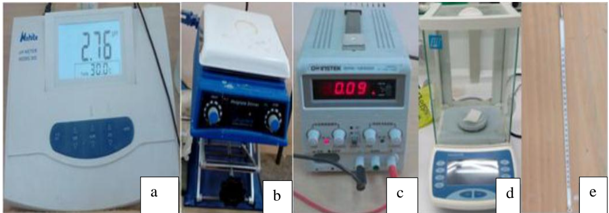
Fig III. 7 : Matériels utilisés dans l'électrodéposition : a) PH-mètre ; b) Agitateur mécanique ; c) Générateur de courant continu ; d) Balance électronique ; e) Thermomètre
