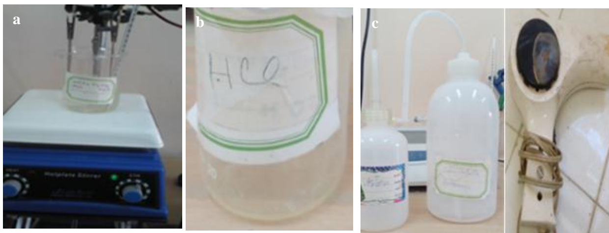
Fig III. 4 : a) Dégraissage, b) Décapage, c) Rinçage ; Séchage.
