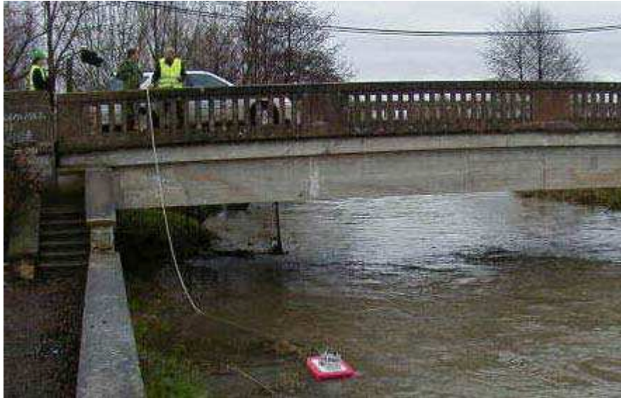
Figure (2,7) : Utilisation de l'ADCP.
