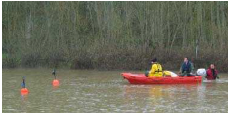
Figure (2,4) : utilisation des flotteurs. (Gautier, 2007)
