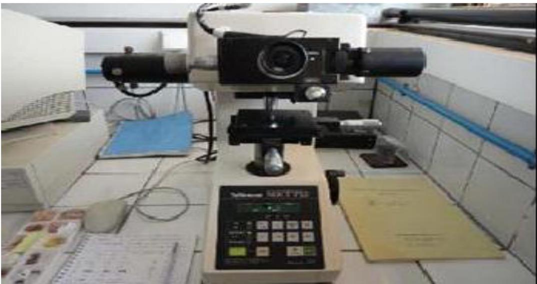
**Figure (II.16) :** Microduromètre Matsuzawa MXT 70.
