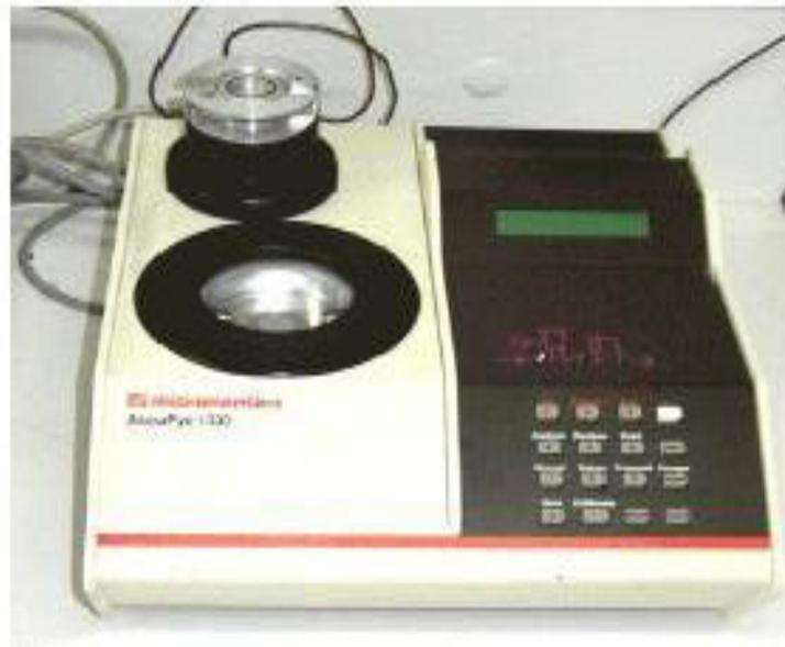
**Figure (II.8) :** Pycnomètre à hélium modèle ACCUPYC 1330 MICROMERITICS.
