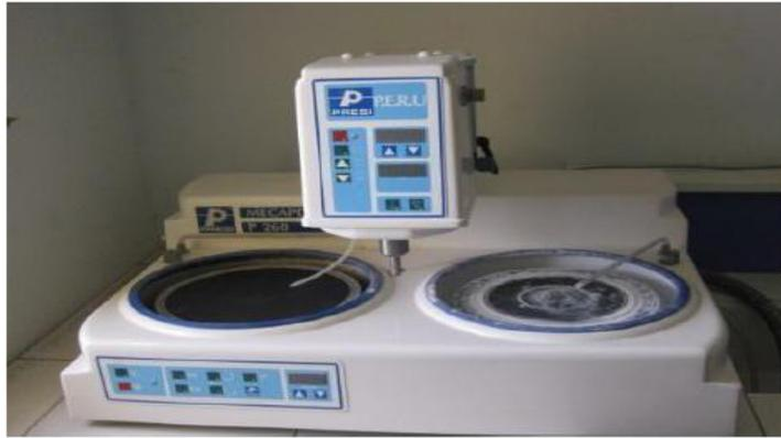
**Figure (II.3): Polisseuse de type Presi Mecapol P 260**
