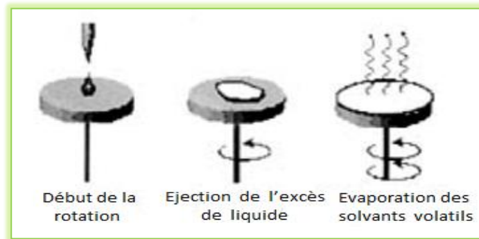
Figure I-13: Schéma représentant le principe de préparation de film mince par La méthode de tournette [8].
