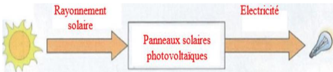
Fig. I.1 : principe de la conversion photovoltaïque de l'énergie solaire.
