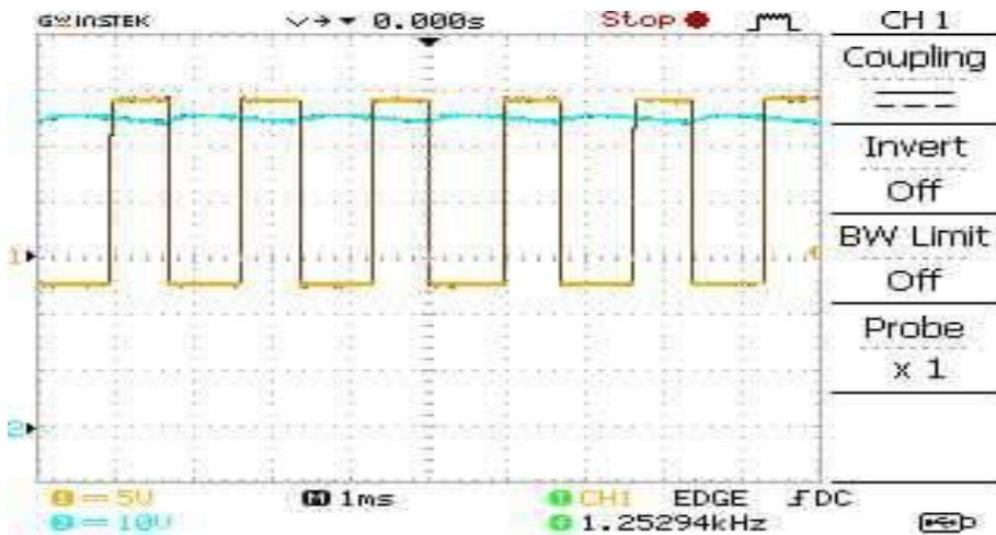
Figure III.18 : La tension de sortie (élevée) avec le signal de commande
