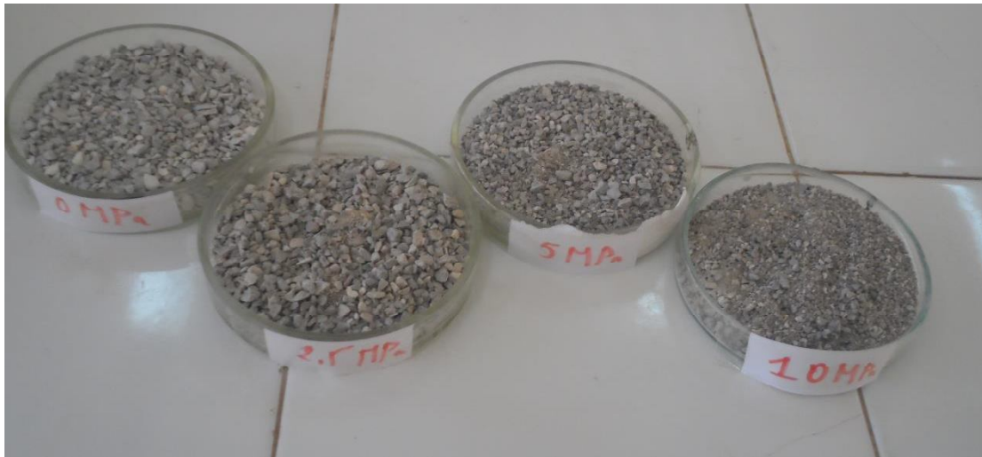
Figure 2.12 : Eprouvettes de sable carbonaté après des essais oedométriques sous différents niveaux
