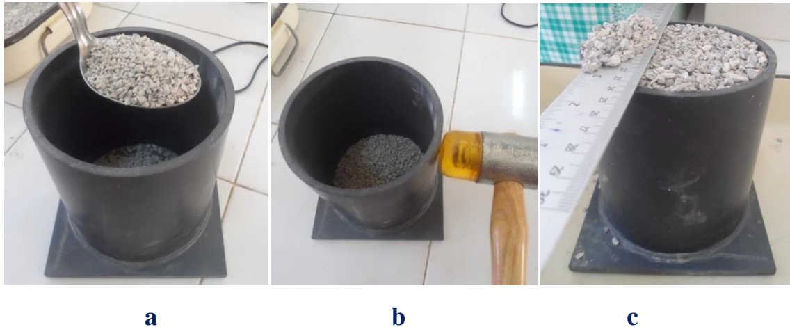
Figure 2.7 : Préparation l'indice de densité minimum ( e_{min} ), a) mise en place le sable dans le mole pour former une couche, b) vibration avec un petit marteau, c) Enlever le sable en excès.
