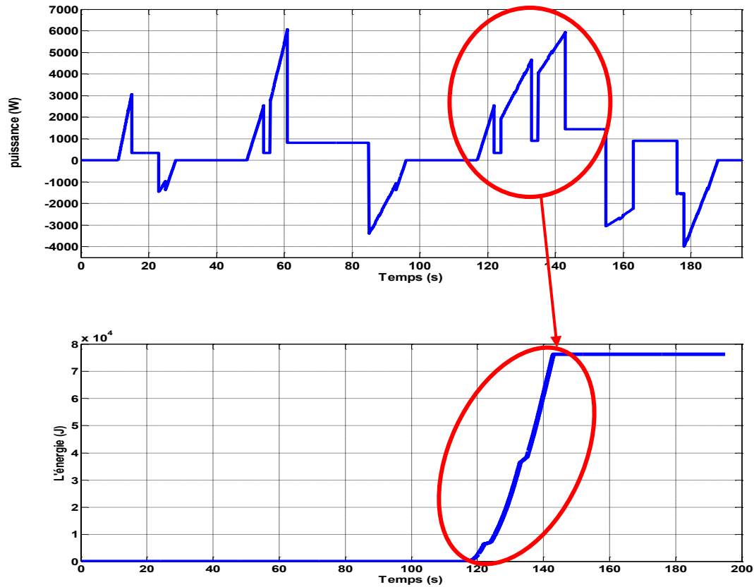
Figure .III. 10 : l'énergie nécessaire à délivrer par supercondensateurs
