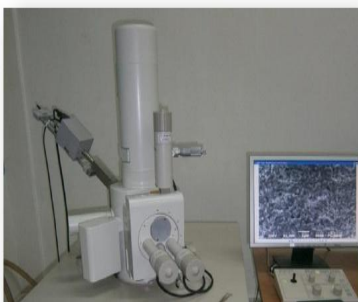
Figure II.11 : Le schéma d'un microscope électronique à balayage et de type JEOL JSM-6390lv.
