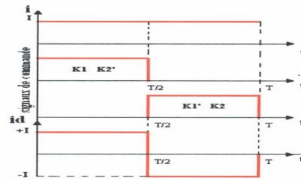
Figure I.9.b. Signaux de commande et pont monophasé d'onde des courants.
