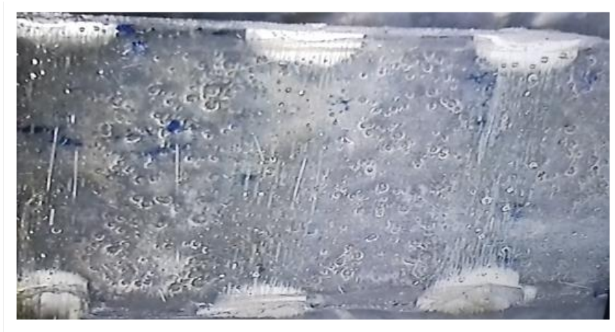
Fig.III.15. bulles d'air. Image microscopique ( \times 60 )
