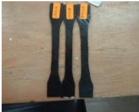
Fig.III.12. des éprouvettes de traction [45_2, -45_2]_{AS} et [45_2, -45_2]_S
