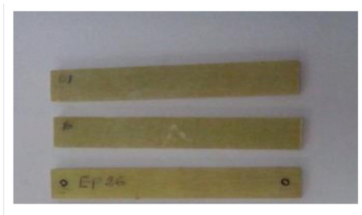
Fig.III.14. Dimension des éprouvettes stratifiées [45_2,-45_2]_{as} et [45_2,-45_2]_s .
