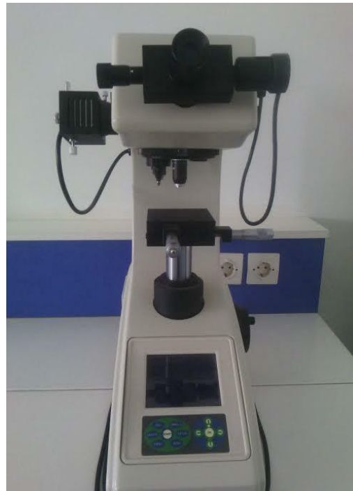
Figure III.2: Micro-duremètre Vickers de type HVS -1000 Z.
