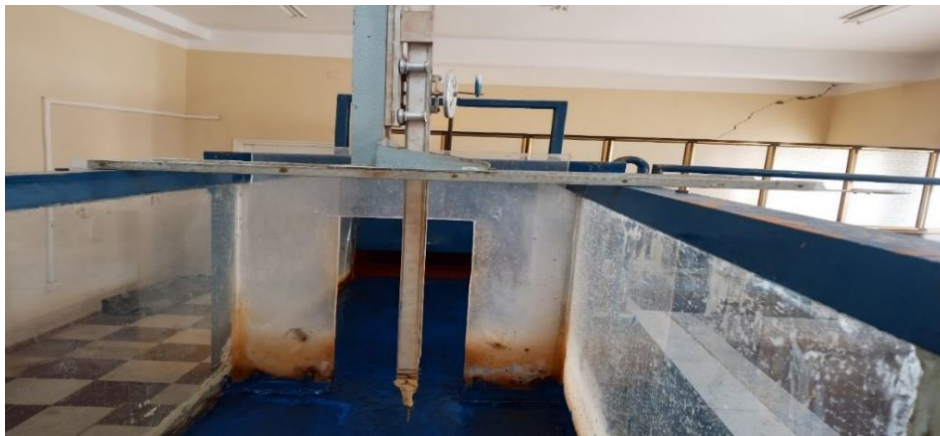
Figure 3.8: Photographie du déversoir rectangulaire sans hauteur de pelle avec contraction latérale ayant servi à la mesure du débit.
