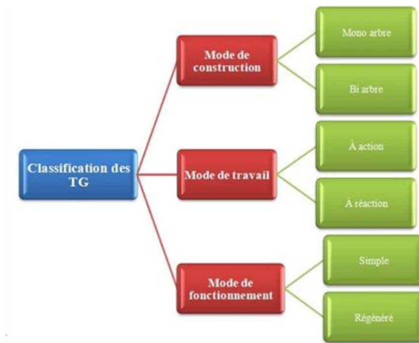
Figure I.3: Classification des turbines à gaz
