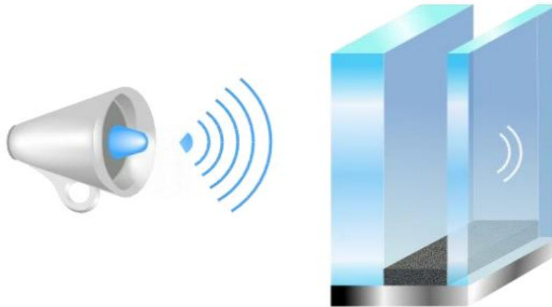
Figure 16 : Principe du double vitrage dissymétrique Source: DR attache Amel -nouveau matériau 2021
