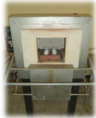
incinération dans un four à moufle à 550 C°
