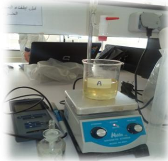
Titration d'une solution du miel avec une solution de Na OH (0.1N).
