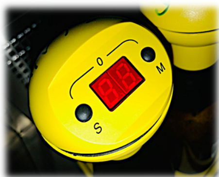
Figure 29: Réglage du Zéro (00) de la tête de l'OXITOP.
