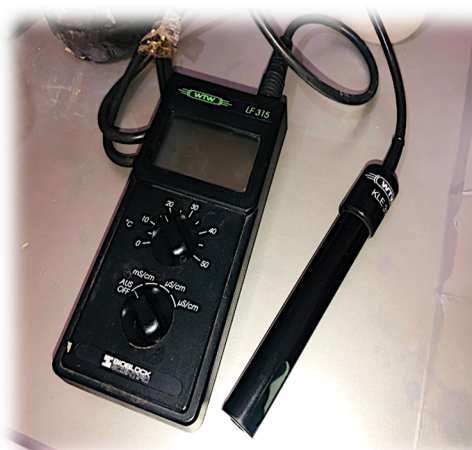
Figure 20 : Conductimètre Bioblocscientific LF 315
