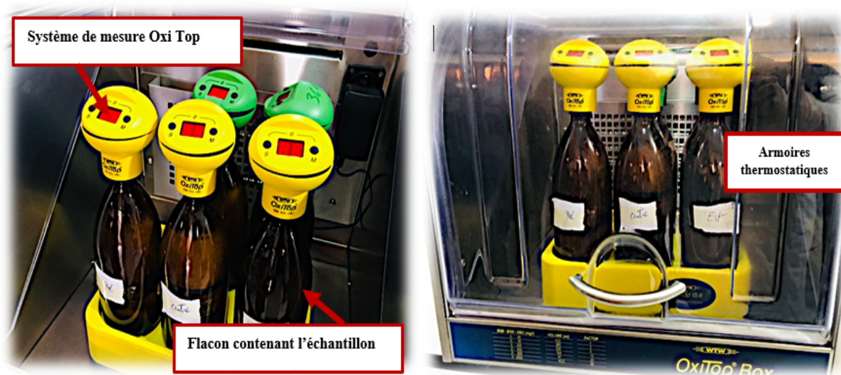
Figure 28: Appareillage utilisé pour la mesure de la DBO 5
