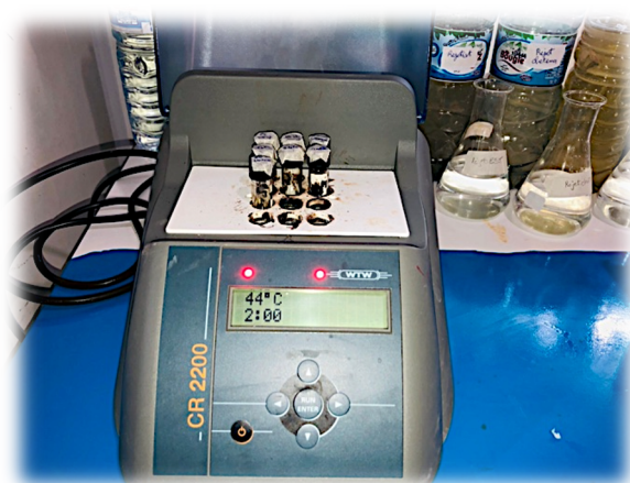
Figure 32 : Bloc chauffant DCO avec capot de protection
