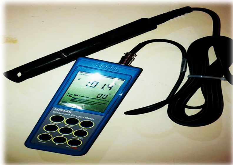
Figure 22 : Oxymètre HANNA HI 9146 utilisé au laboratoire.
