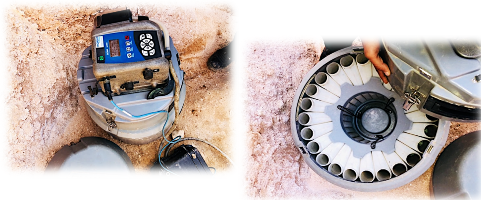
Figure 37: Échantillonneur utilisé pour les prélèvements nocturnes et diurnes.
