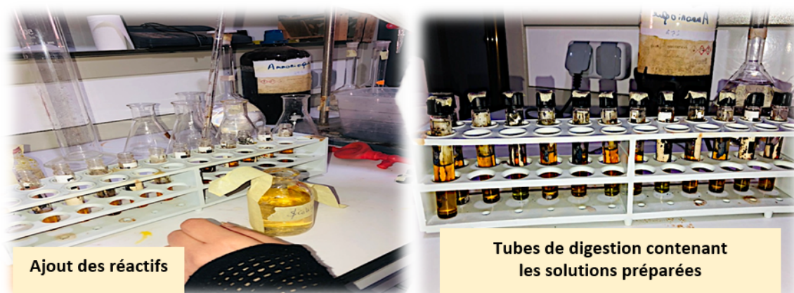
Figure 31 : Introduction des réactifs (Réactif de digestion et la solution catalytique)
