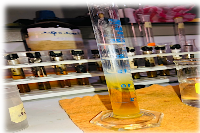
Figure 33 : Dilution de l'échantillon à la sortie du bloc chauffant DCO
