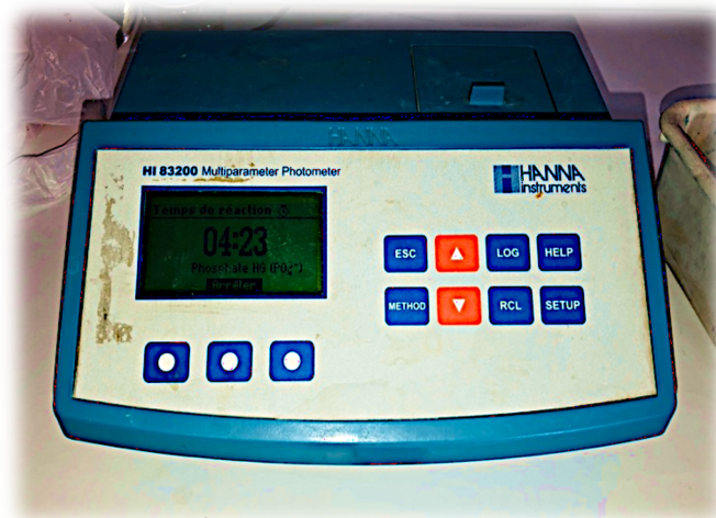
Figure 23 : Multiparamètre HI 83200-02 pour le dosage des ions ( \text{PO}_4^{3-} ) et ( \text{NH}_3\text{-N} ) et des composés azotés
