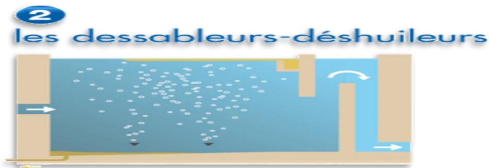
Figure 07: Le processus d'élimination des huiles et des graisses [5].
