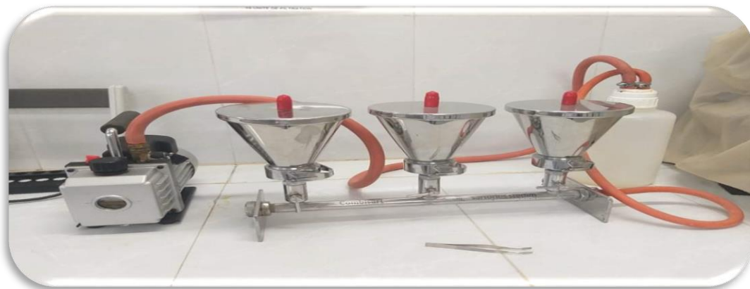
Figure 30 : Unité de filtration avec pompe a vide.
