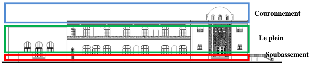
Figure V-11 : Composition de la façade de l'Hôtel Palace.
