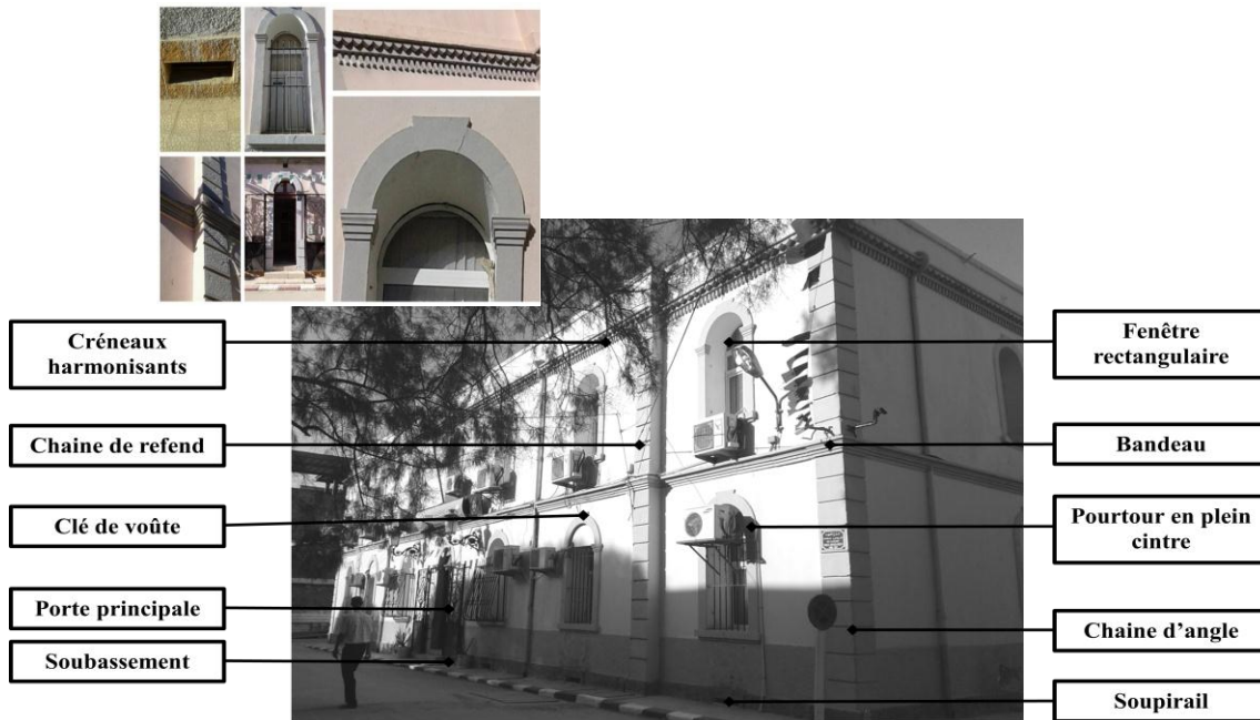
Figure V-57 : Eléments de la façade de la Caserne de Gendarmerie– Biskra Source : Auteur.
