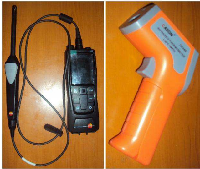
Figure 5.8 : Appareils de mesures : le Testo 480 et le thermomètre infrarouge "Cason-Ca 380". (Source : Auteur, 2016)
