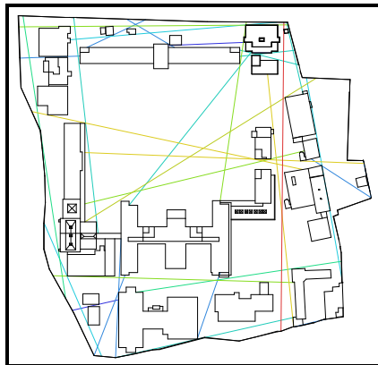
Figure VII. 10. Carte de l'intégration visuelle de l'analyse axiale du plan de masse du CHU de Sétif. Source: Auteur.
