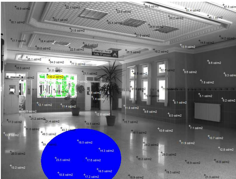
Annexe XIII- figure. 23. Carte de luminance générée à partir d'une photo HDR de l'espace d'accueil et d'attente simulée à l'aide du logiciel EVALGLARE. Source: auteur.
