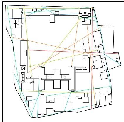
Figure VII. 4. Carte de connectivité visuelle de l’analyse axiale du plan de masse du CHU de Sétif. Source: Auteur.
