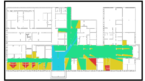
Figure VII. 51. Carte de Step Depth à partir de l’analyse VGA des urgences de l’hôpital d’Ain Azel. Source: auteur.
