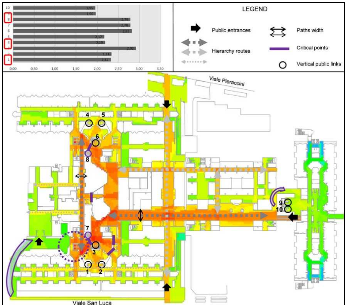
Annexe XII- figure. 17. Intégration; cas de tout le fonctionnement au rez-de-chaussée du bâtiment du nouveau projet Chirurgie- PS. Dans les diagrammes de barre le reachability des liens verticaux pour les utilisateurs publics est indiqués.
