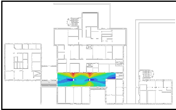
Figure VII. 55. Carte d'intégration à partir de l'analyse VGA des urgences de CHU de Sétif. Cas des portes fermées. Source: auteur.
