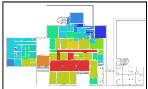
Figure VII. 38. Carte d'intégration à partir de l'analyse convexe des urgences de Chu de Sétif. Source: auteur.
