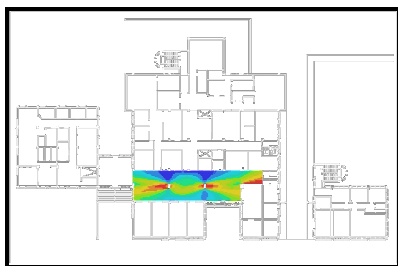
Figure VII. 61. Carte d’entropie à partir de l’analyse VGA des urgences de CHU de Sétif. Cas des portes fermées. Source: auteur.
