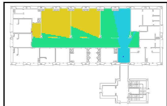
Figure VII. 144. Carte de la step depth à partir de l’analyse VGA du service de la médecine interne (femmes) de l’hôpital Eulma. Cas des portes fermées. Source: auteur.
