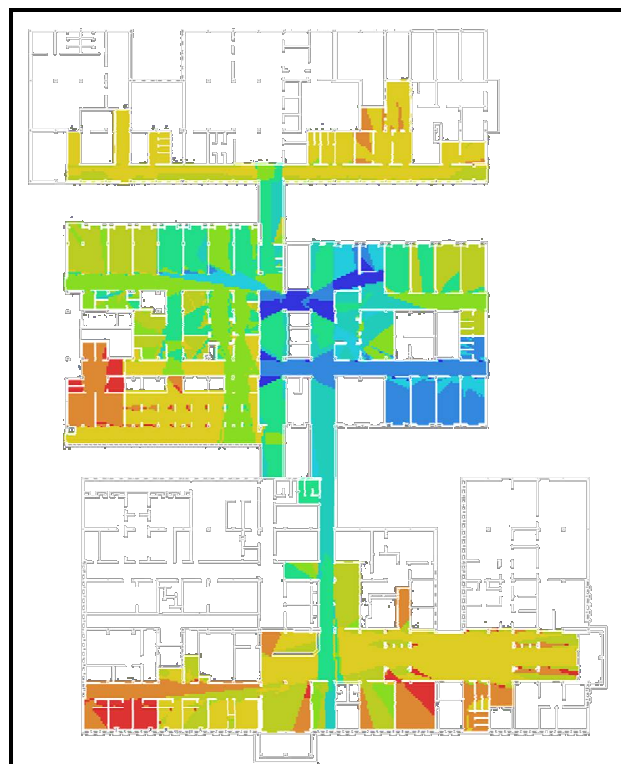
Figure VII. 162. Carte de l’entropie à partir de l’analyse VGA de l’hôpital Ain Azel. Cas des trois blocs (A, B et C) assemblés. Source: auteur.
