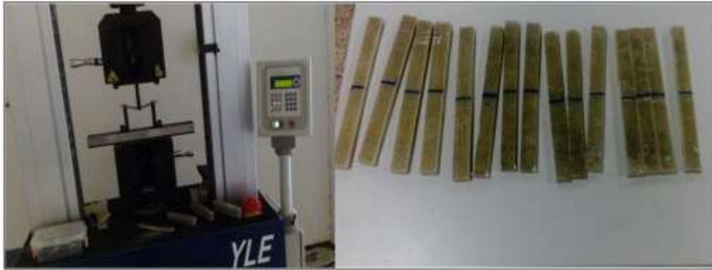
Figure (II, 17): Essai de flexion trois points des éprouvettes en PRV.
