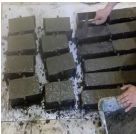
(d) Remplir des éprouvettes en béton fibré
