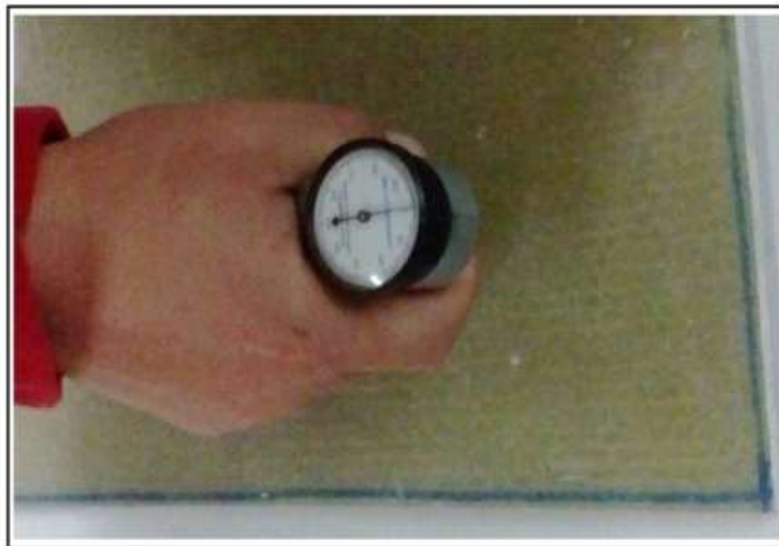
Figure (II, 18): Essai de détermination de dureté de Barcol.
