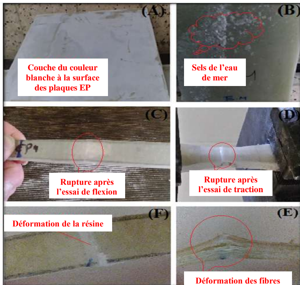
Figure (IV, 13): surfaces des éprouvettes conservées dans différents milieux dans une durée de 365 jours.
