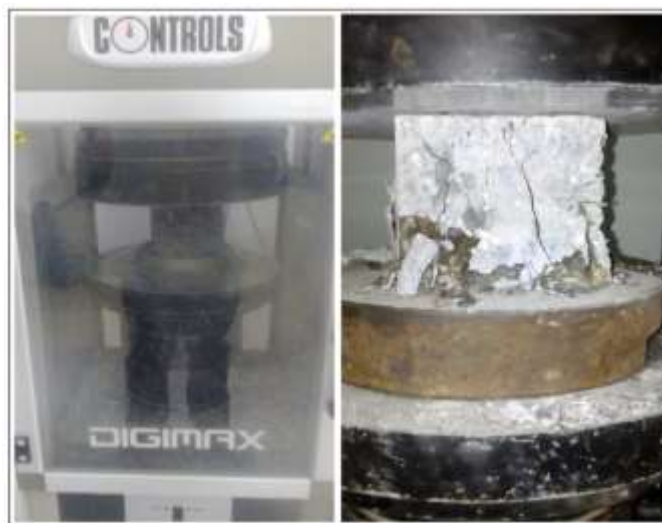
Figure (II, 10): Dispositif pour l'essai de résistance à la compression.
