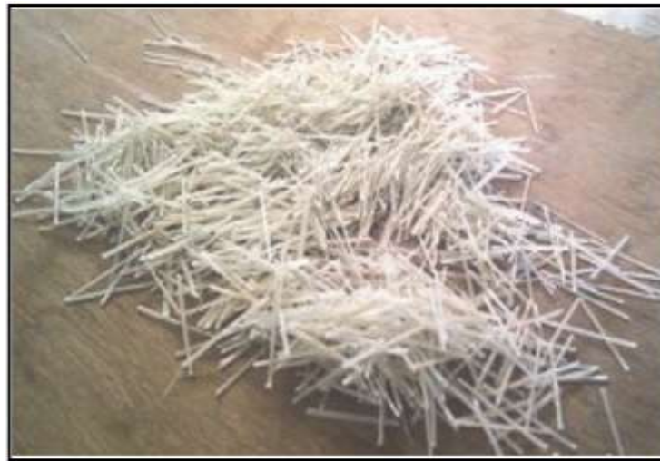
Figure (I, 01): Fibres de verre coupées type E. [47]
