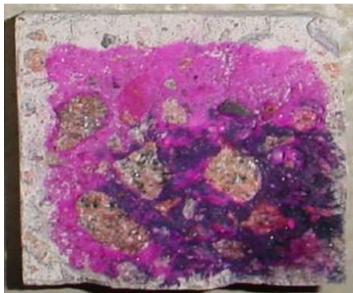
Figure (I, 17): Essai de détermination de la profondeur de carbonatation du béton [112].
