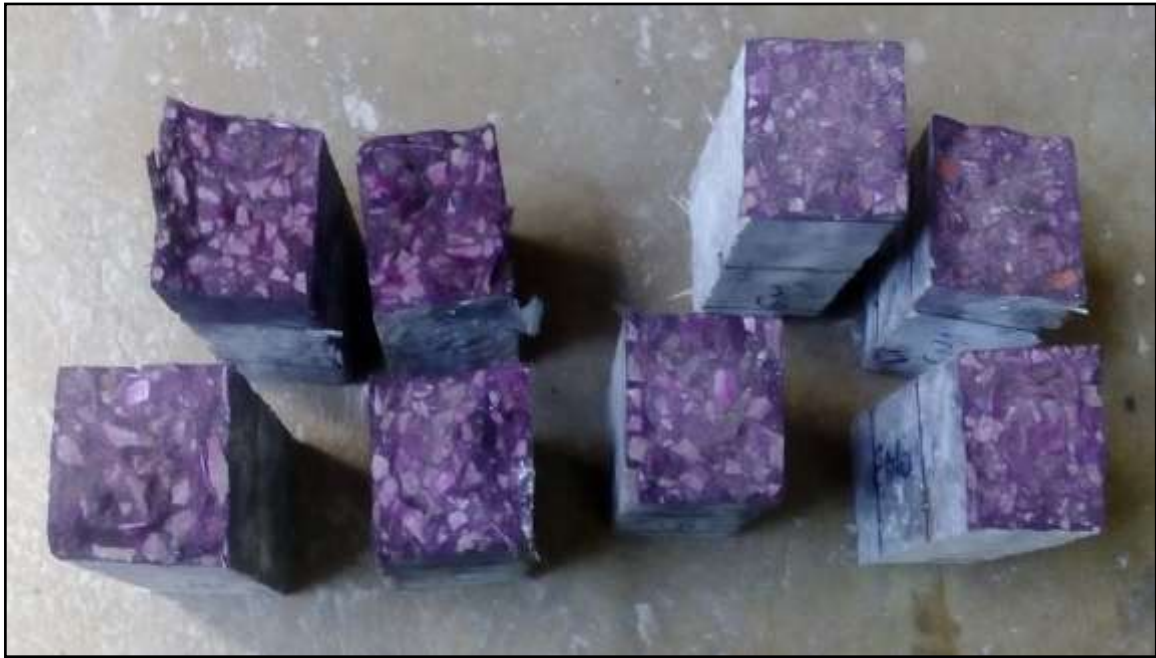
Figure (III, 12): Mesure de la profondeur de carbonatation des éprouvettes en béton conservées dans différents milieux.
