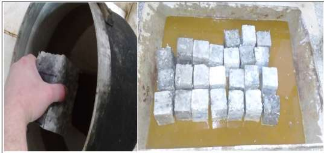
Figure (II, 12): Essai de l'absorption capillaire des éprouvettes en béton au labo LTPE.
