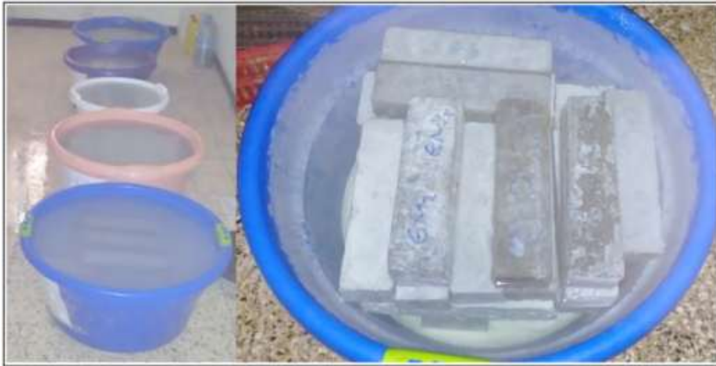
Figure (II, 09): Conservation des éprouvettes en béton de fibres dans l'eau de mer.
