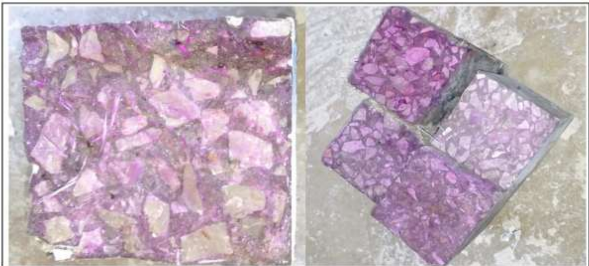
Figure (II, 13): Essai de mesure la profondeur de carbonatation des éprouvettes en béton de fibre.
