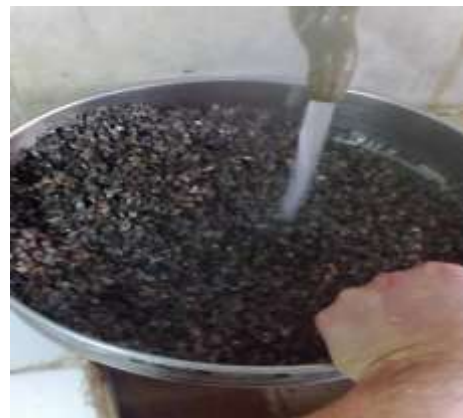
(b) Essai de propreté des granulats.
