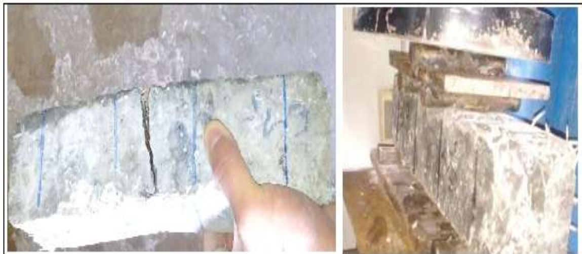
Figure (II, 11): Essai de traction par flexion des éprouvettes en béton de fibres conservées dans différents milieux.
