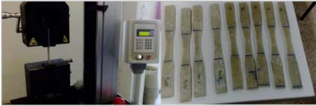
Figure (II, 16): Essai de traction axiale des éprouvettes en PRV conservées dans différents milieux.
