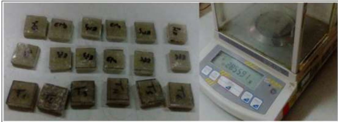
Figure (II, 19): Essai d'absorption d'eau des éprouvettes en PRV.
