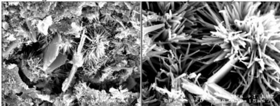
Figure 5.8 : Observation au MEB du CPJ (20 % du laitier) hydraté à 365 jours.
