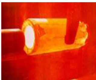
Figure.1.4 Réchauffage avant formage
