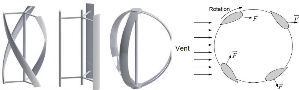
Figure 1.8 : Principe du rotor Darrieux, [20].
