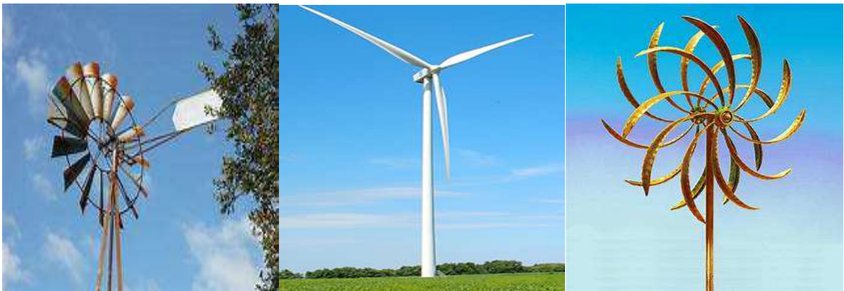
Figure 1.9 : Eoliennes à axe horizontal
