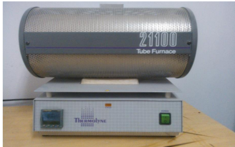
Figure IV.3 : Four de traitement thermique.
