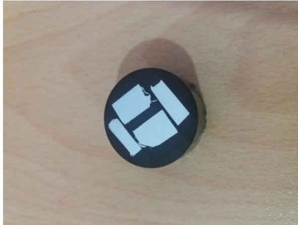
Figure IV.5 : Echantillons coupés et enrobés.
