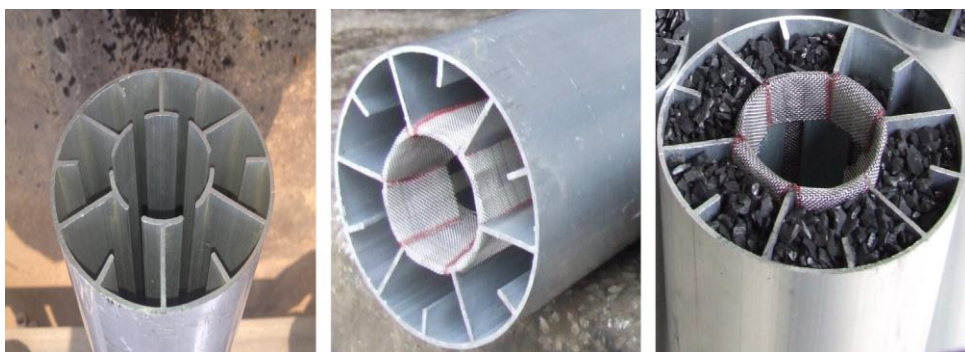
Fig. 1.42 : Configuration du lit tubulaire à ailettes internes [122].
