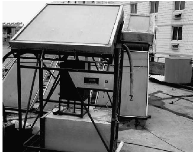
Fig. 1.23: Photographie de la machine solaire de production de glace par adsorption de Luo et al. [74].
