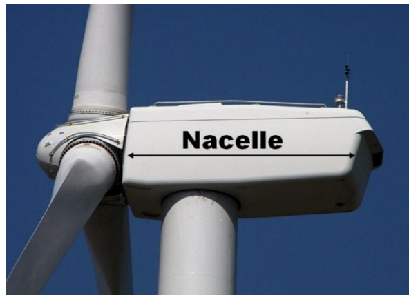
Fig.II.4. La nacelle d'une éolienne à axe horizontal [WEB5].
