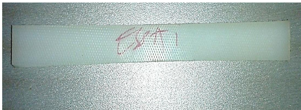
Figure IV-3. Matériau objet d'étude (polyamide 6)
