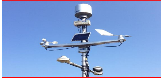
Figure IV.11 : Station météo à transmission GPS-
