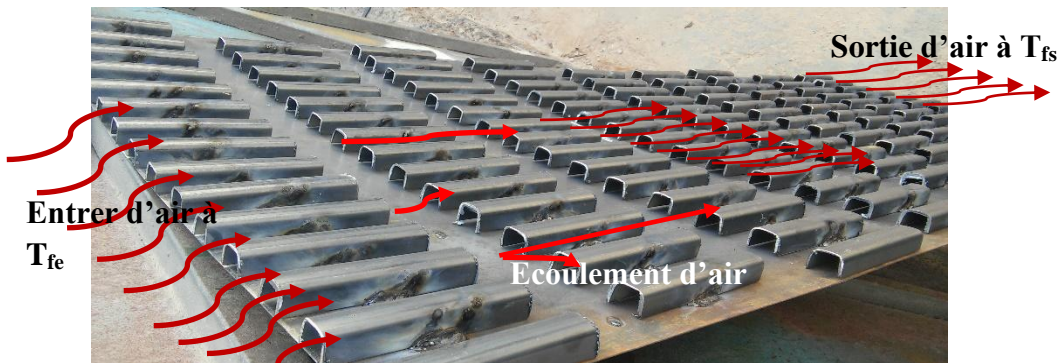
Figure IV.9. Photo du canal d'écoulement et emplacement des chicanes
