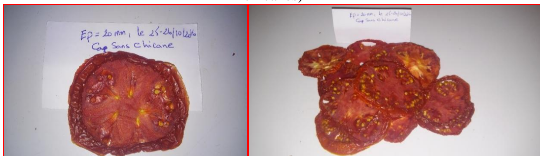
Figure V. 61. Aspect final des lamelles de tomate séchées (Ep =20 mm, capteur sans chicanes)
