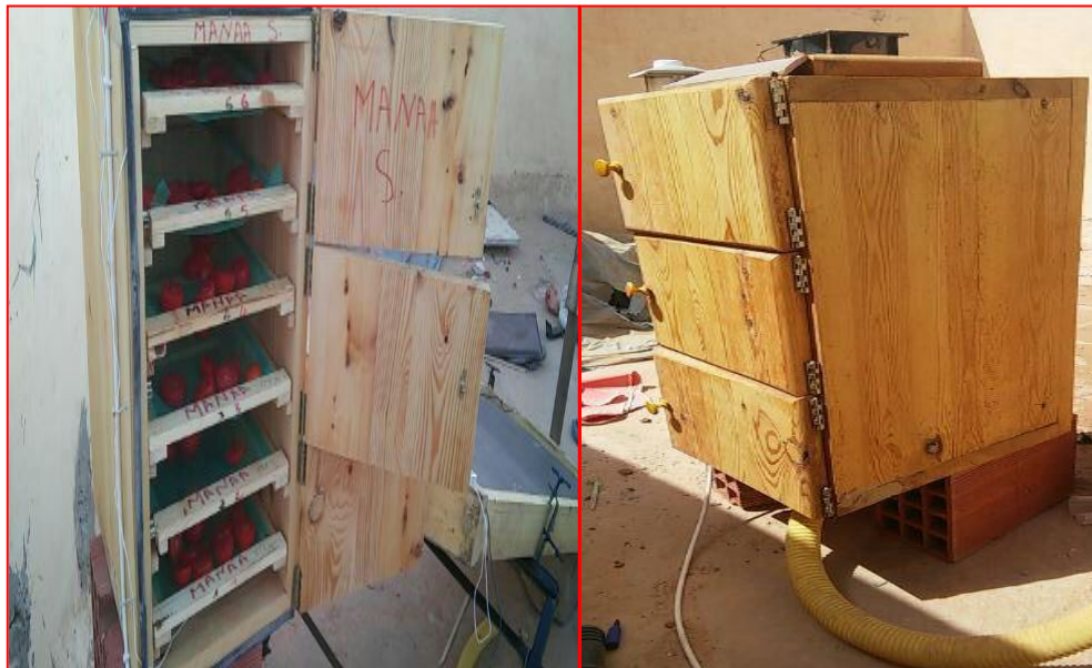
Figure IV.3. Photos de l'armoire de séchage avec claies
