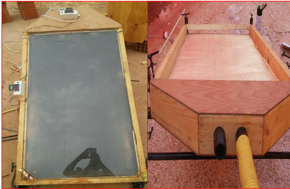
Figure IV.2. Photo du capteur solaire plan à air conçu
