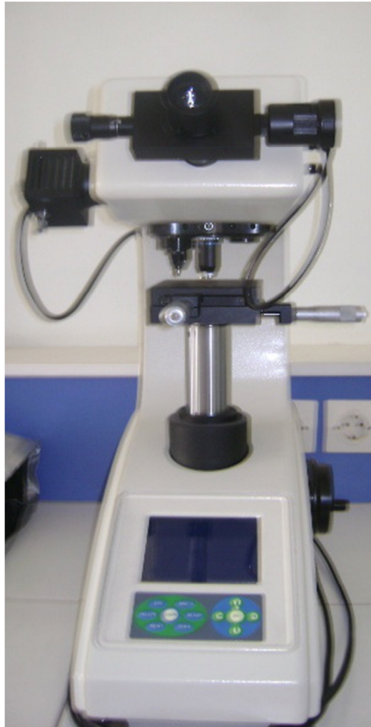
Figure II.4: Micro-duremètre Vickers de 402MVD Z,
