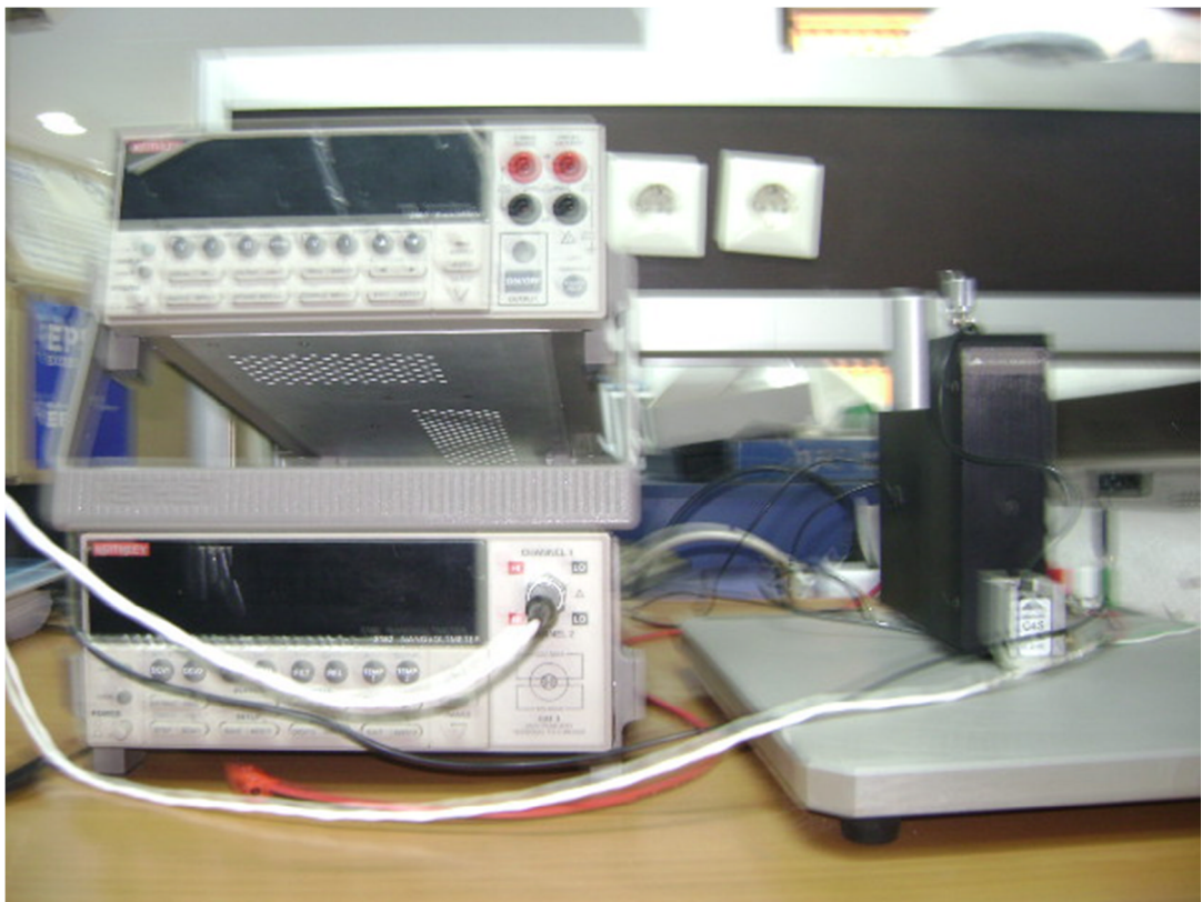
Figure II.7: Resistivimétrie électrique (quatre points)
