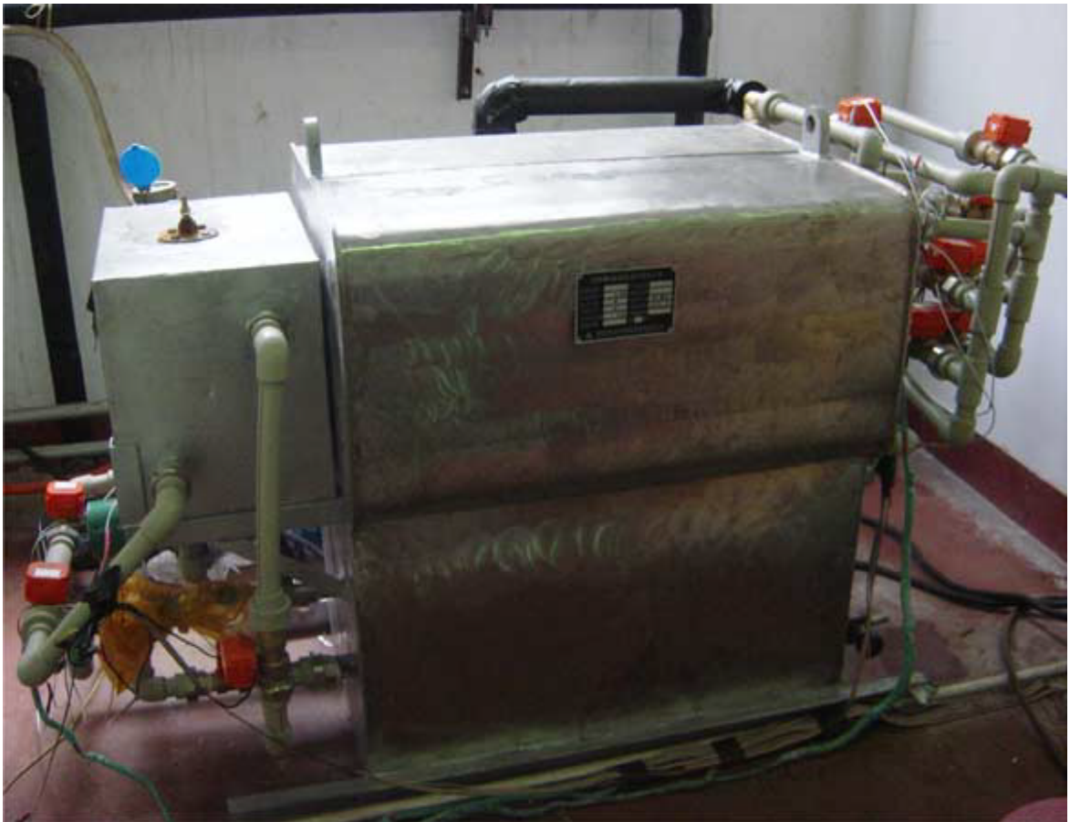
Fig. 14. Le nouveau refroidisseur développé d'adsorption à eau glacée d'eau (Seconde génération) [Liu et Wang (2004)].
