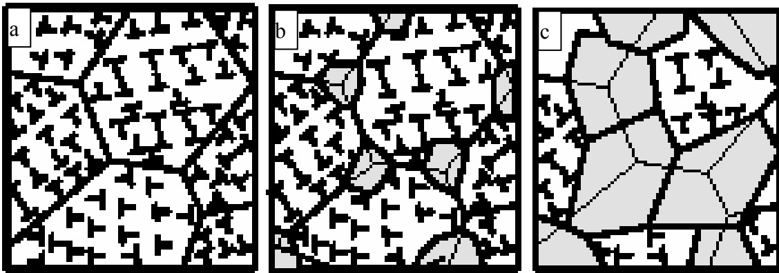
Fig. II.6: Représentation schématique de recristallisation: Métal écroui (a), Formation de nouveaux grains (b), après recristallisation, germination et croissance de nouveaux grains (c).[15].
