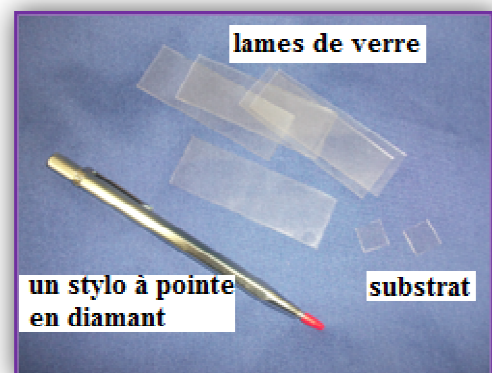
Figure II.2: Des substrats en verre coupés à l'aide d'un stylo coupant
