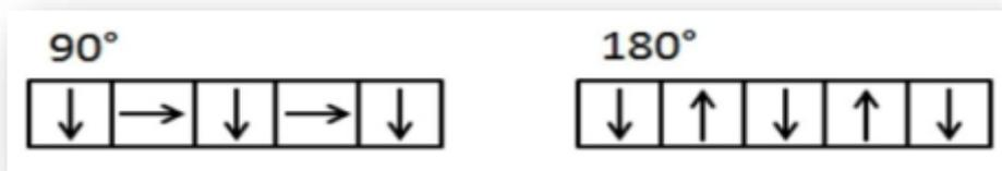
**Figure I.9 :** Représentation des domaines perpendiculaires ( $90^\circ$ ) et antiparallèles ( $180^\circ$ ).
