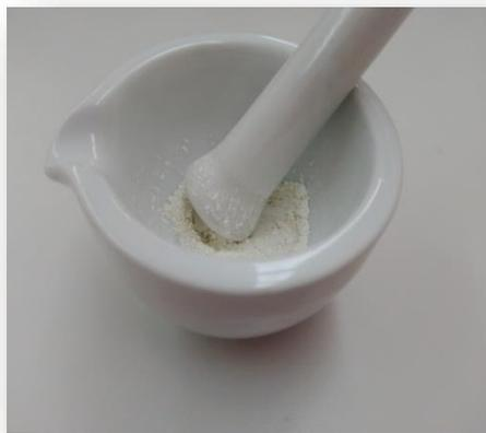
**Figure II.9 :** Rébroyage après la calcination.
