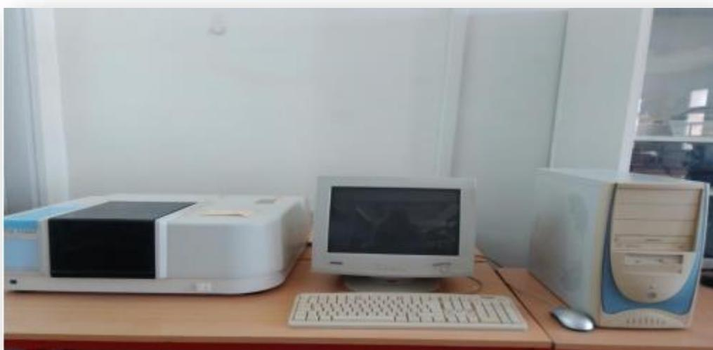
**Figure II.15 :** Spectromètre infrarouge a transformée de Fourier FTIR
