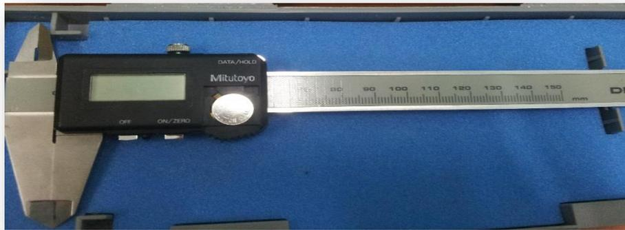
**Figure II.13 :** Pied à coulisse électronique.
