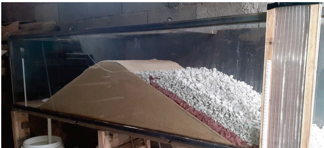
Fig. 7 Configurations de drainage des trois modèles physiques.
