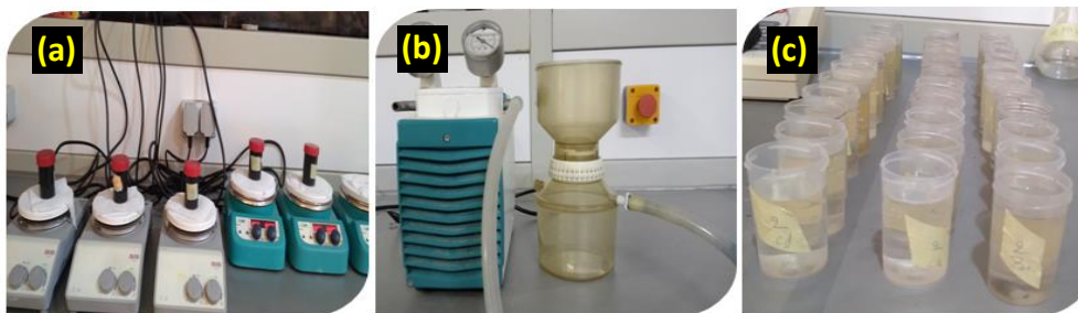
Figure I-10 : Méthode adoptée pour tous les essais d'adsorption en laboratoire : (A) les échantillons sous agitation, (B) Système de filtration sous vide, (C) les échantillons filtrés
