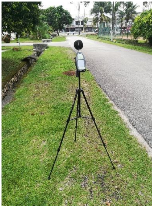
Figure. II.25. La norme NF S 31-010, mise en place du sonomètre (Segaran et al. 2020).
