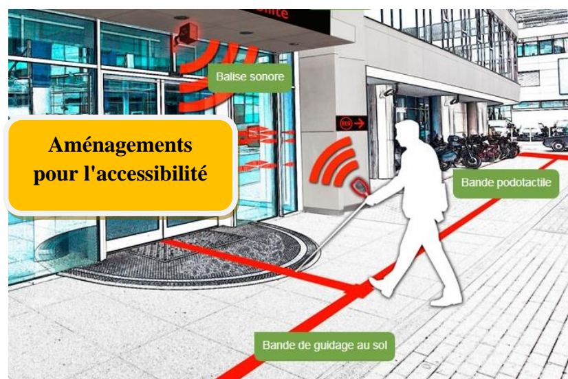
Figure. I.9. Aménagements et dispositifs d'aide à l'accessibilité des personnes déficientes visuelles ( http://dupli-accessibilite.fr/plan-entree )
