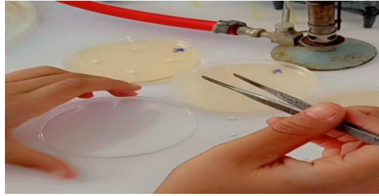
Figure 4: Placer des disques de test sur le tapis microbien.
