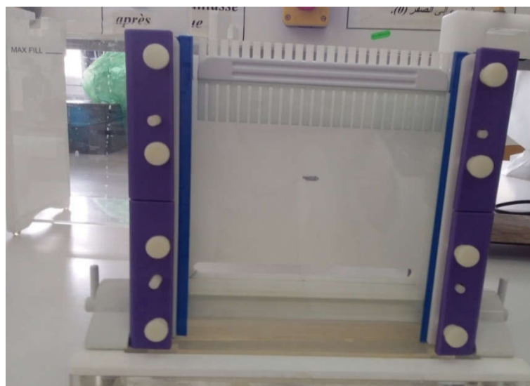
Figure06 . Montage des plaques
