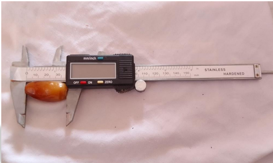
Figure (10) : Mesurer les dimensions de datte par un pied à coulisse numérique photo originale (Lebchaki, 2024)
