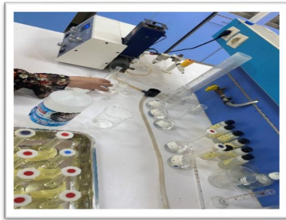
Figure 21 Lecture dosage des éléments sodium au spectromètre à flamme (original)
