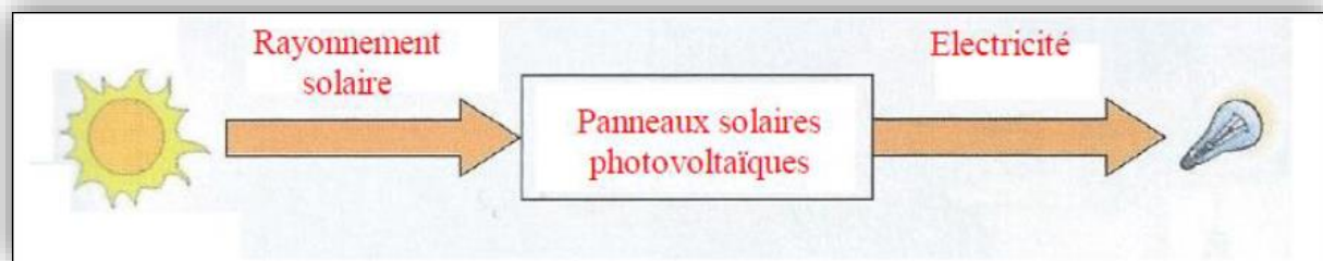
Figure 14: Principe d'énergie solaire
