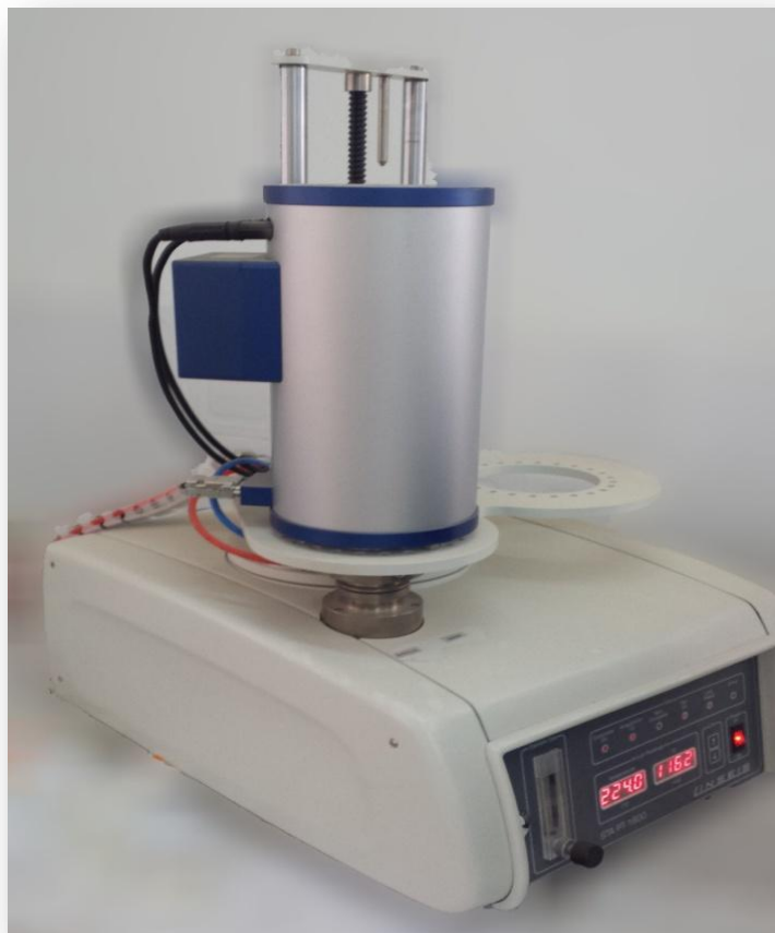
Figure II.2 : Appareil ATD-ATG de marque LINSEIS STA 2400
