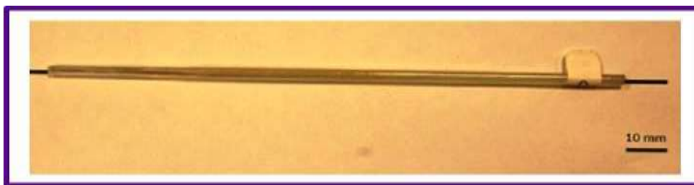
Figure IV.11. Barreaux saphir tiré avec une vitesse de tirage rapide ( v_{\text{tirage}}=3\text{mm/min} )
