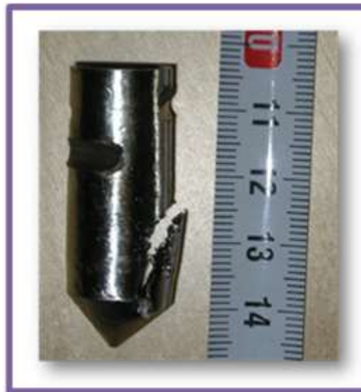
Figure III.2. Endommagement d'un creuset d'iridium en raison de la surfusion du bain liquide.
