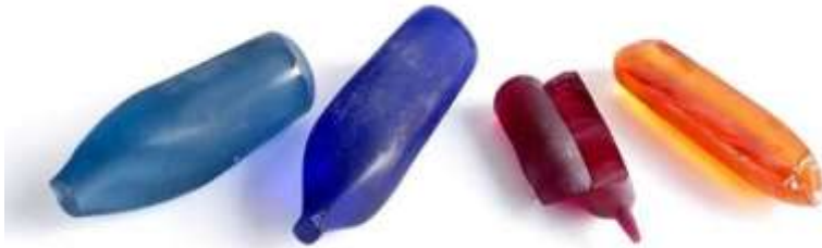
Figure I.11. Cristaux développés par la méthode de Verneuil.
