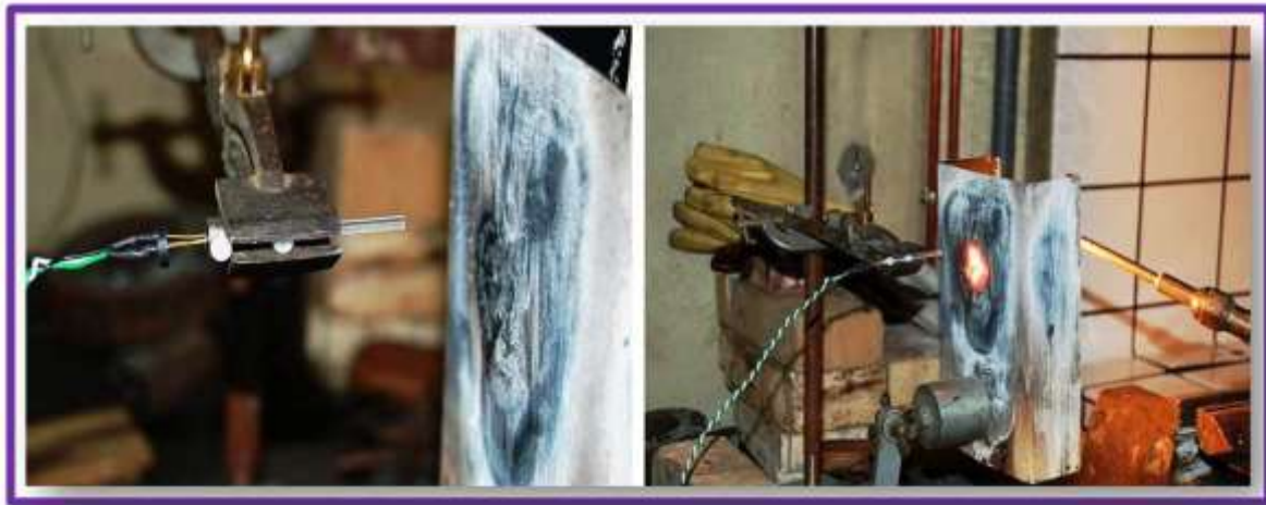
Figure V.6. Les essais de mesure de température à travers l'utilisation de barreaux de saphirs de diamètre 3 mm en tant que détecteur de rayonnement
