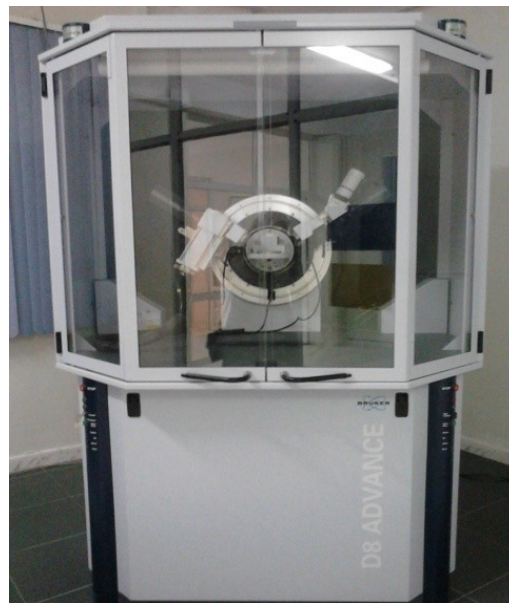
Figure II.12 : Image d'un diffractomètre de type (D8 ADVANCE)
