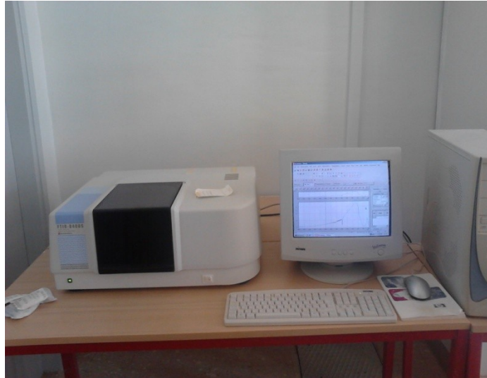
Figure II.14: Image d'un spectrophotomètre infrarouge
