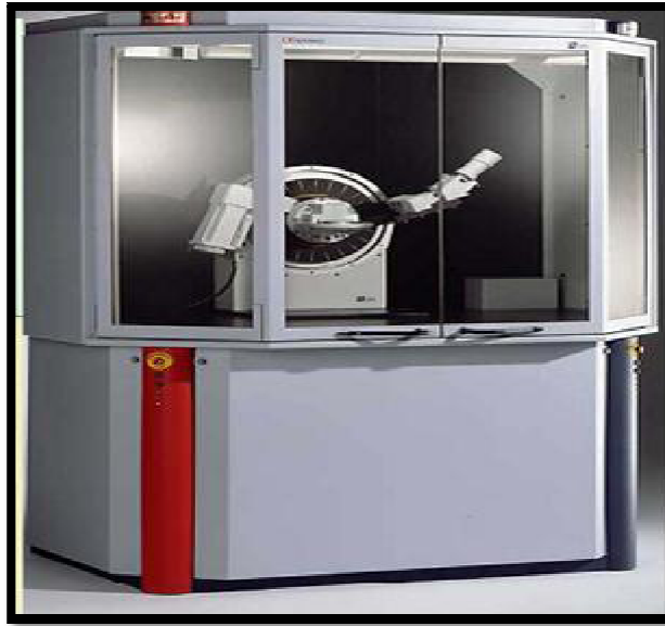
Figure (IV.10): diffractomètre du type BRUKER-AXS type D8 .
