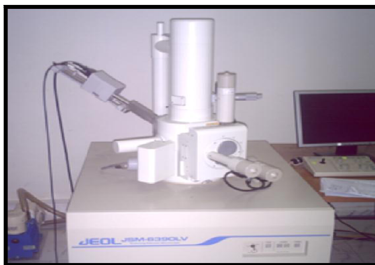
Figure (IV.15): Microscopie électronique à balayage de type JEOL JSM-6390LV .
