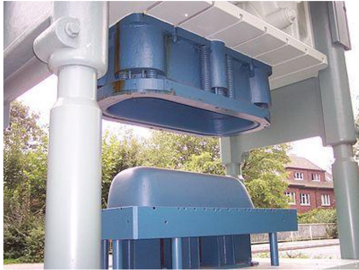
Figure 3: Presse à emboutir (en gris) les baignoires avec son outillage (en bleu)
