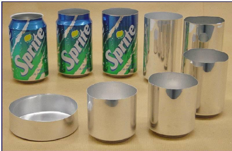
Figure 4 : Etapes de la production de canettes à partir de découpes circulaires par emboutissage profond, emboutissage de reprise et étirage de parois
