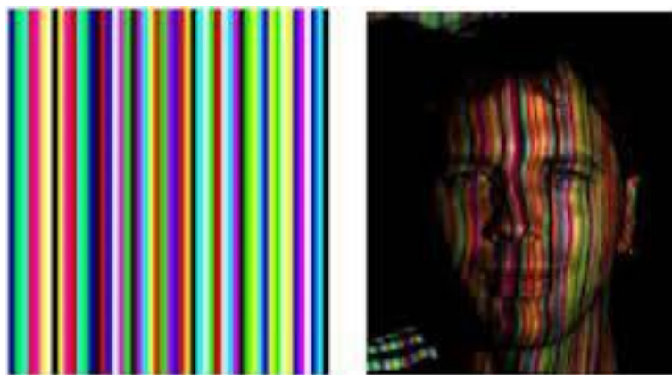
Figure 1.7: Exemple de lumière structurée (à gauche) et sa projection sur un visage [35].
